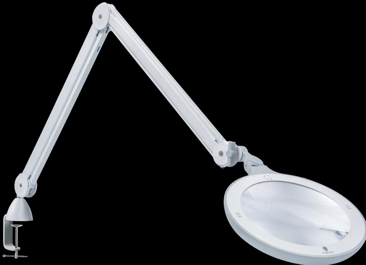
Die neue Omega 7 ist eine moderne, ergonomisch gestaltete Lupenleuchte mit einer 17,5cm großen, leichten Linse (3 Dioptrien, 1,75-fache Vergrößerung). 60 ultrahelle Daylight-LEDs und zwei Helligkeitsstufen sorgen für eine optimale Erkennung von Details. Der mehrfach verstellbare Leuchtenarm und -kopf mit Flügelmutter ermöglicht eine einfache Ausrichtung der Leuchte mit nur einer Hand. Der lange Arm mit integrierten Federn sorgt außerdem für eine mühelose Bewegung und genaue Positionierung.
