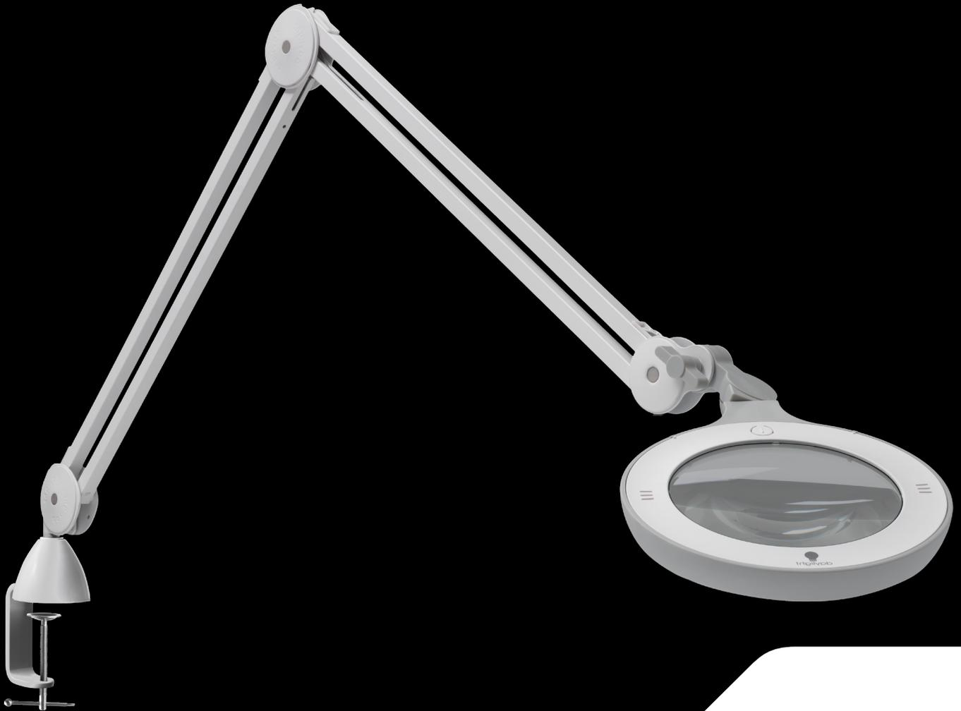
Die Omega 5 Lupenleuchte besitzt eine 12,7cm große Glaslinse mit einer Vergrößerung von 3 Dioptrien (1,75X). Eine zusätzliche Vergrößerungslinse mit 5 Dioptrien (2,25X) ist ebenfalls enthalten. Die Leuchte verfügt über vier Helligkeitsstufen, die nach Bedarf eingestellt werden können. Der flexible Arm mit integrierten Federn ermöglicht ein präzises Ausrichten der Leuchte. Das ästhetisch ansprechende weiß/graue Finish fügt sich perfekt in jede professionelle Umgebung ein.
